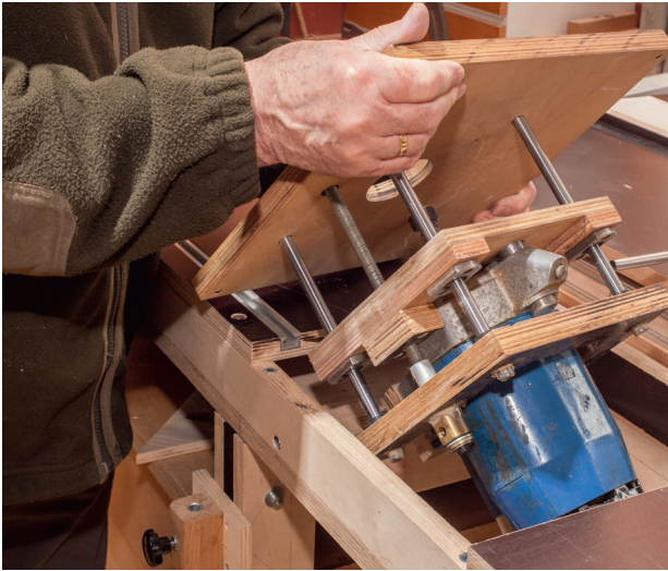
Der Frästisch mit der Oberfräse wird als Baugruppe in die Werkbank eingesetzt...
