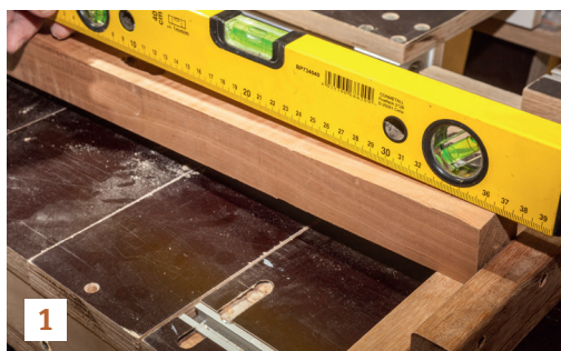
Das Kantholz wird schräg eingespannt...
