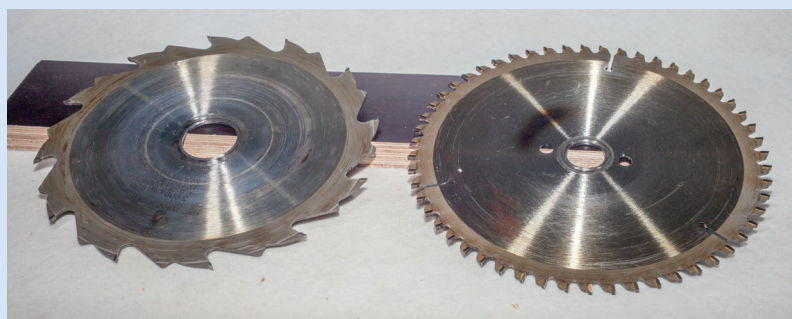
Sägeblatt für den Längsschnitt (links); Sägeblatt für den Querschnitt (rechts)
