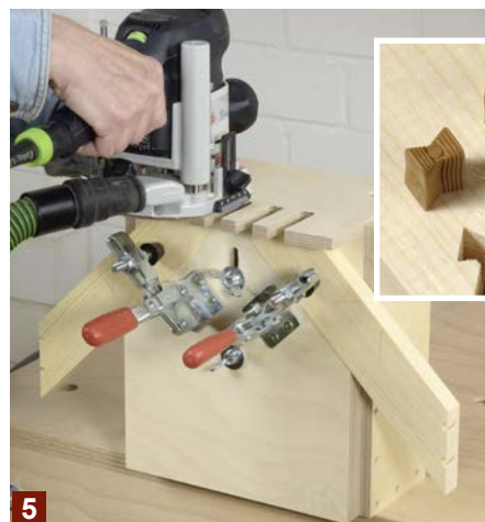
5 Mit dem Gehrungsanschlag kann der Multidübler auch stationär genutzt werden, um beispielsweise solche Schwalbenverbinder einzufräsen.
