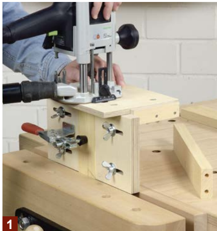
1 Mit dem Multidübler setzen Sie präzise und wiederholgenaue Runddübel in jeden rechteckigen Querschnitt (auch dicke Balken!).
