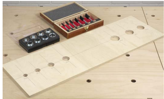
Eine einfache Lochschablone, sowie ein paar unterschiedlich große Kopierhülsen und Nutfräser – mehr braucht es nicht, um präzise Durchgangs- oder Sacklöcher in nahezu jedem Durchmesser von 11 bis 44 mm herzustellen.
