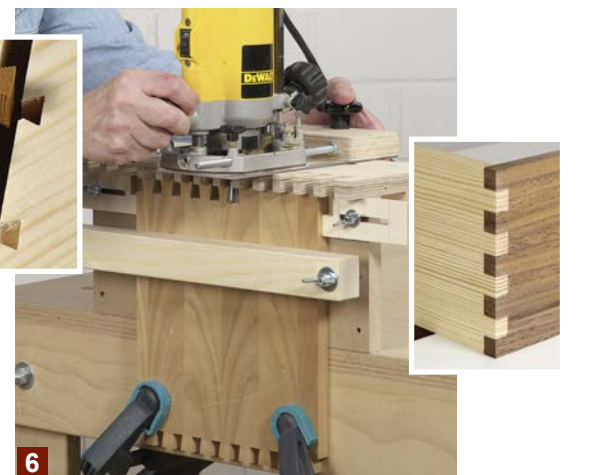
6 Und richtig span(n)end wird es, wenn der Multidübler zum Fräsen offener Schwalben- oder Fingerzinkenverbindungen eingesetzt wird.
