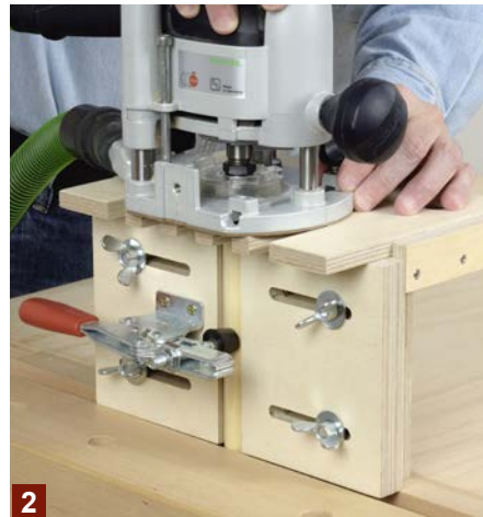
2 Aber auch in viele runde, drei-, sechs- oder achteckige Querschnitte lassen sich absolut senkrecht sitzende Runddübel einbohren.
