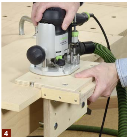
4 Auch präzise und vor allem aussrissfreie Lochreihen im 32-mm-Raster sind mit dem Multidübler überhaupt kein Problem.
