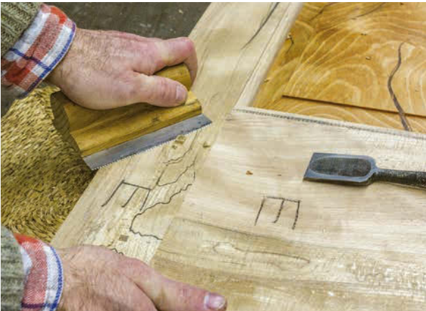
Schritt 26: Schneiden Sie die Holznägel mit einer Furnier- oder Dübelsäge bündig ab. Achten Sie darauf, die umgebende Oberfläche nicht zu verkratzen.
