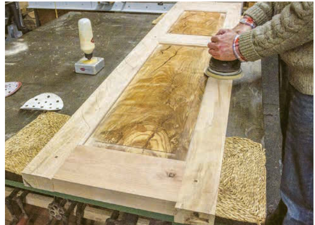
Schritt 27: Schleifen Sie die Quer- und Längsfriese mit 320 Schleifpapier glatt und eben. Die Füllungen werden nicht wieder geschliffen.
