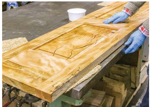
Schritt 29: Behandeln Sie die Oberflächen auf beiden Seiten mit mehreren Schichten Öl, um einen seidigen Glanz zu erreichen.
