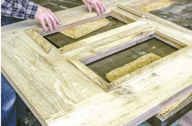
Schritt 15: Schneiden Sie den Rahmen aus Füllungsstäben auf Gehrung, und verleimen Sie ihn. Sichern Sie die Ecken mit Klebeband, und setzen Sie dann Zwingen an.
