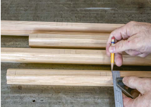
Schritt 13: Reißen Sie die Gehrungsschnitte an den Sprossen an, sie treffen in 12,5 mm Abstand von jeder Seite der vollen Sprossenbreite aufeinander.
