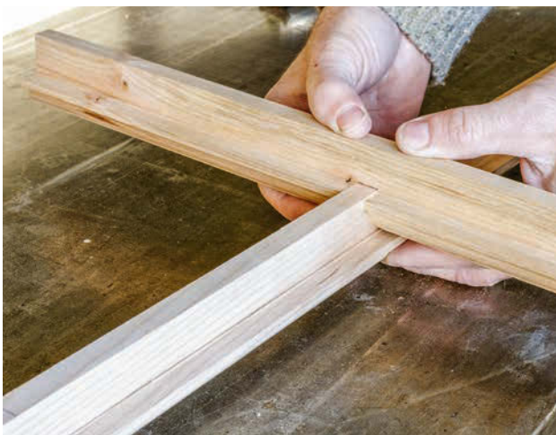
Schritt 14: Stecken Sie die Sprossen trocken zusammen, um die Passung zu prüfen.
