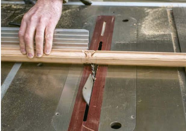
Schritt 15: Schneiden Sie die Gehrungen an der Tischkreissäge mit dem Queranschlag und auf 45° geneigtem Sägeblatt an.
