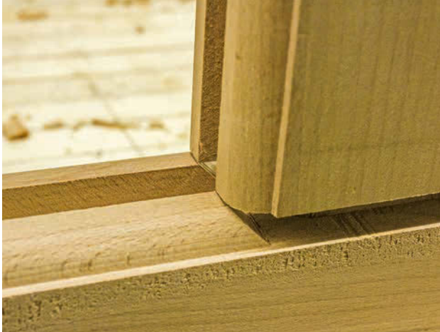
Schritt 18: Stecken Sie die Verbindungen zur Probe zusammen, bevor Sie die Querriese auf Gehrung schneiden, um sicherzustellen, dass sie mit den angerissenen Linien übereinstimmen.
