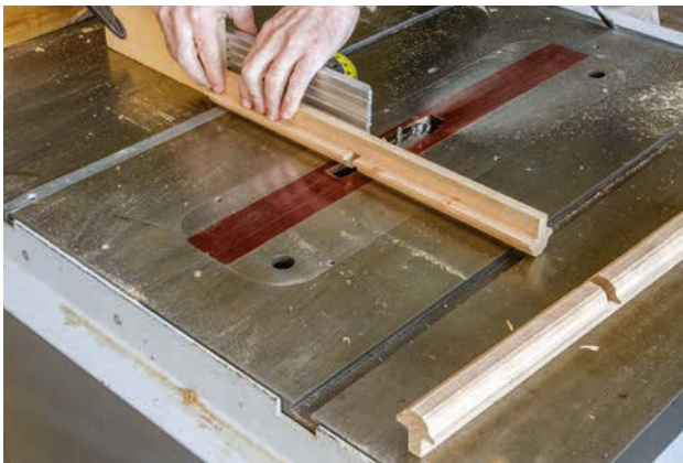
Schritt 14: Verwenden Sie einen Stoppklotz, um die Fälze mittig in den waagerechten Sprossen anzuschneiden.
