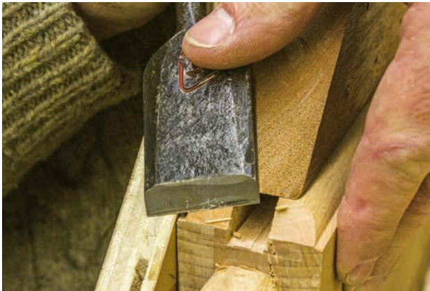
Schritt 18: Stechen Sie die Gehrungen an den Profilierungen mit der Gehrungslade bis zur Zapfenbrüstung ab.
