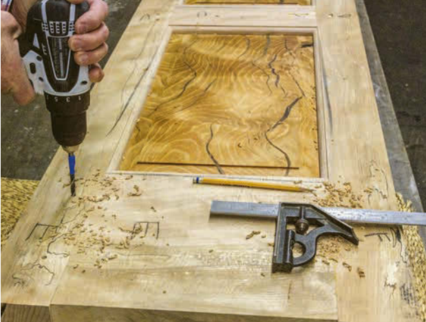
Schritt 26: Bohren Sie mittig in jeden Schlitz 6-mm-Führungslöcher für die 6 x 6-mm-Holznägel.
