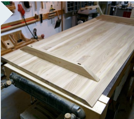
8 | Fräsen Sie die Dübellöcher (14 x 75) in die Gratleisten. Diese sollten etwas Spiel haben, um das Aufsetzen der Unterkonstruktion später zu vereinfachen. Markieren Sie ihre Position außen, um diese später auf die Tischbeine übertragen zu können (Schritt 20).
