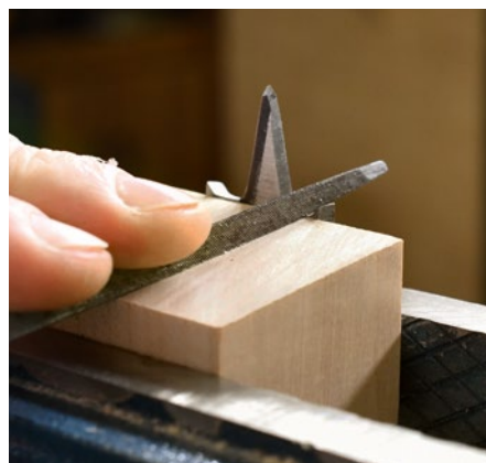
Scharfmacher: Eine einfache, im Winkel von 10° angeschnittene Führung kann das Führen beim Schärfen erleichtern. Wenige Züge mit der Feile reichen aus. Spitze und Vorschneiden bearbeiten Sie aber nicht.
