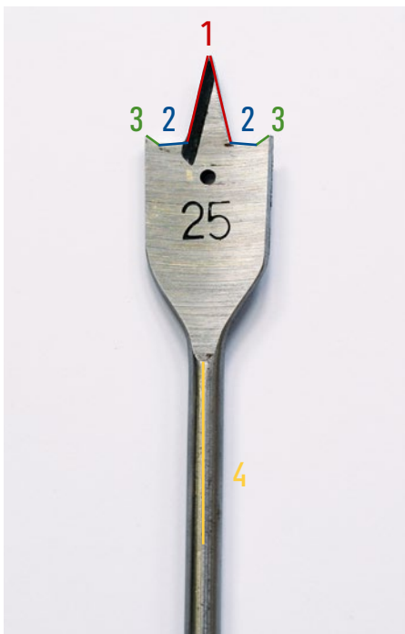
Aufbau des Flachbohrers: Spitze (1), Grundschneiden (2) und Vorschneiden (3). Der Bohrerstängel (4) ist oft entweder rund oder mit einer Sechskant versehen. Im Gegensatz zu Spiralbohrern sind Flachbohrer eines Sets in der Regel gleich lang.
