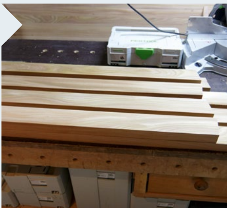
9 | Für das Tischuntergestell werden nun die beiden Seitenteile angefertigt. Um die 80 mm Stärke der Einzelteile zu erreichen, doppelte Sie je zwei 40 mm-Stücke auf. Kappen Sie vor dem Aufdoppeln der Beine je ein Teil im richtigen Winkel (siehe Zeichnung).
