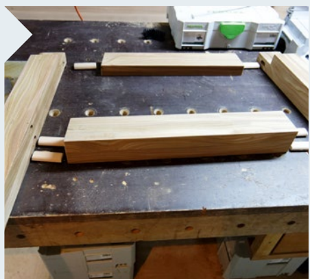
11 | Die Dübellöcher (14 x 75 mm) sind zum Ausrichten mit etwas Spiel gefräst. Alternativ kann hier auch auf Flachdübel oder klassische Verbindungen zurückgegriffen werden.
