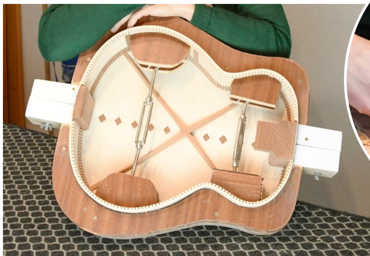
In dieser Vorrichtung werden die Zargen der Gitarre nach dem Dämpfen und Biegen eingespannt. Sie bleiben darin, bis die Kanten geschliffen und sie mit dem Boden und der Decke verleimt sind.
