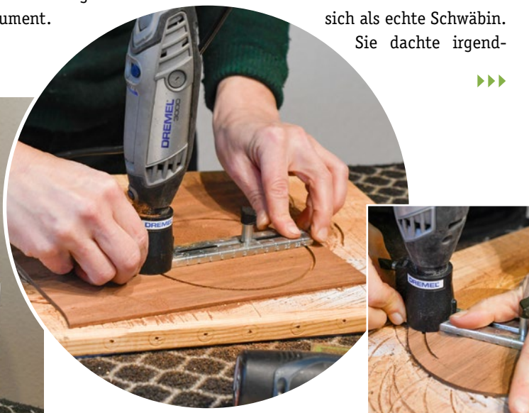
Mit dem Multifunktionswerkzeug und dem Kreisschneider fräst Gabriele Réti die dekorativen Schalloch-Rosetten aus. Im ersten Schritt entsteht ein Ring aus Nussbaum ...
