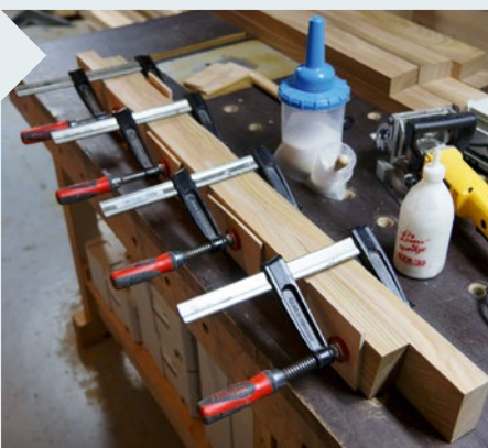
10 | Zur Stabilisierung beim Verleimen der 40-mm-Tischbeinhälften setzen Sie auch hier Flachdübel ein.
