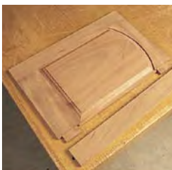
144 Türen aus Rahmen und Füllung
