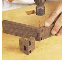
166 Selbst gefertigte Scharniere
