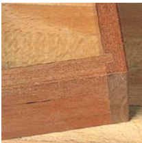
89 Nuten und ange- schnittene Federn
