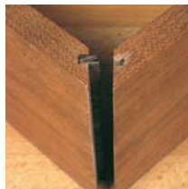
106 Gehrungsverbin- dungen mit losen Federn
