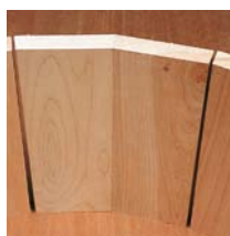
255 Kantenverleimung von Dauben
