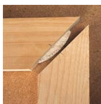
201 Gehrungsverbindungen mit Federn
