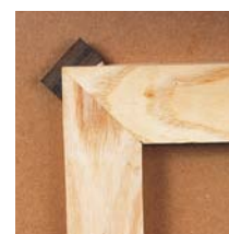
206 Gehrungsverbindungen mit Eckfedern
