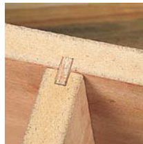
96 Verbindungen mit loser Feder
