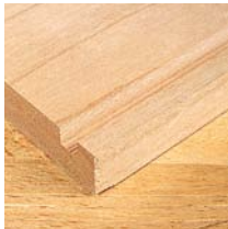
78 Nuten mit der Faser
