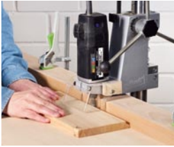
192 Stationäres Fräsen auf einem Bohrständer
