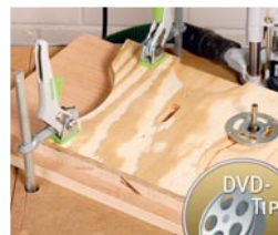
76 Fräsen nach Schablonen mit Kugellager und Kopierhülse
