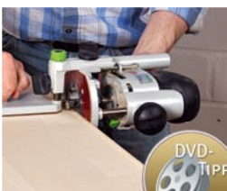
99 Arbeiten mit der Umleimerplatte
