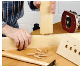
144 Runddübel mit der Oberfräse einbohren – die Dübelsschablone
