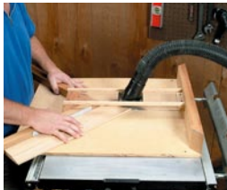
251 Staubabsaugung an Vorrichtungen
