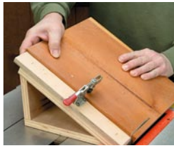
93 In der Nutschiene für den Queranschlag geführt
