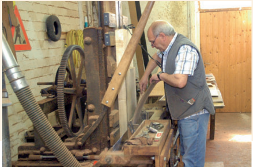
Gesägtes Furnier wie vor 100 Jahren: Noch heute wird es hergestellt, und zwar auf historischen Maschinen.
