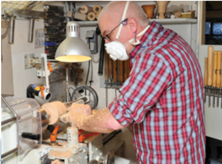
Die Drechselbank wirft Ralf Augustin oft an, um Klüpfel aus Multiplex selbst anzufertigen. Sie nutzen sich durch die spezielle Struktur des Schichtholzes nicht so schnell ab wie Klüpfel aus Massivholz.
