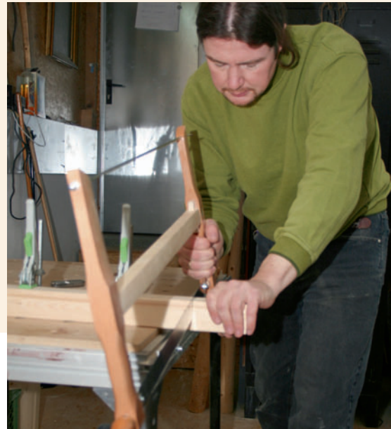
Ein Draht bringt das Blatt auf Spannung: Gestellsägen gehören zu den urchältesten Werkzeugen und sind immer noch nützlich. Seite 14
